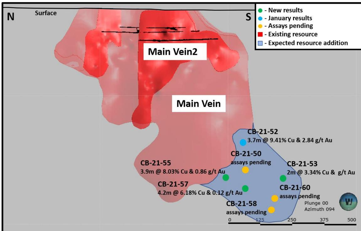
**Abbildung 2.** Längsschnitt des Haupterzgangs bei Corner Bay unterhalb des Intrusionsgangs.
